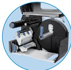
Конструкция из литого алюминия увеличивает стабильность и долговечность устройства.
