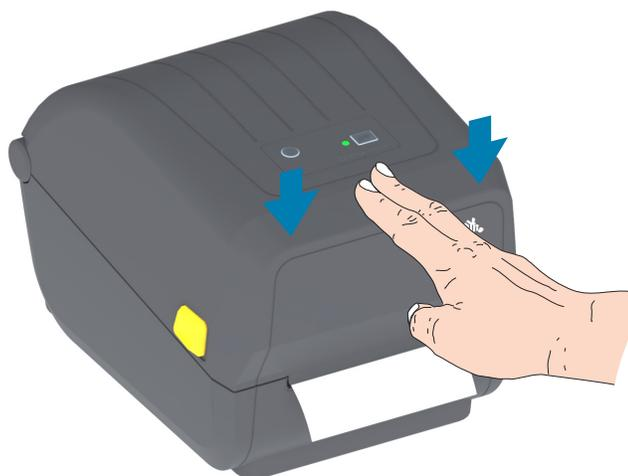
Может потребоваться выполнить калибровку принтера в соответствии с носителем. Необходимо настроить датчики принтера, чтобы считывание этикеток, подложки и расстояния между этикетками работало правильно. В случае загрузки идентичного носителя (размер, поставщик и партия) для подготовки носителя к печати достаточно просто один раз нажать кнопку подачи.
