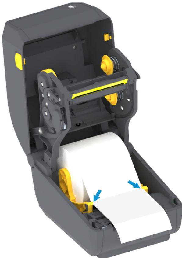
5. Поднимите носитель и выровняйте передвижной датчик в соответствии с типом носителя.
