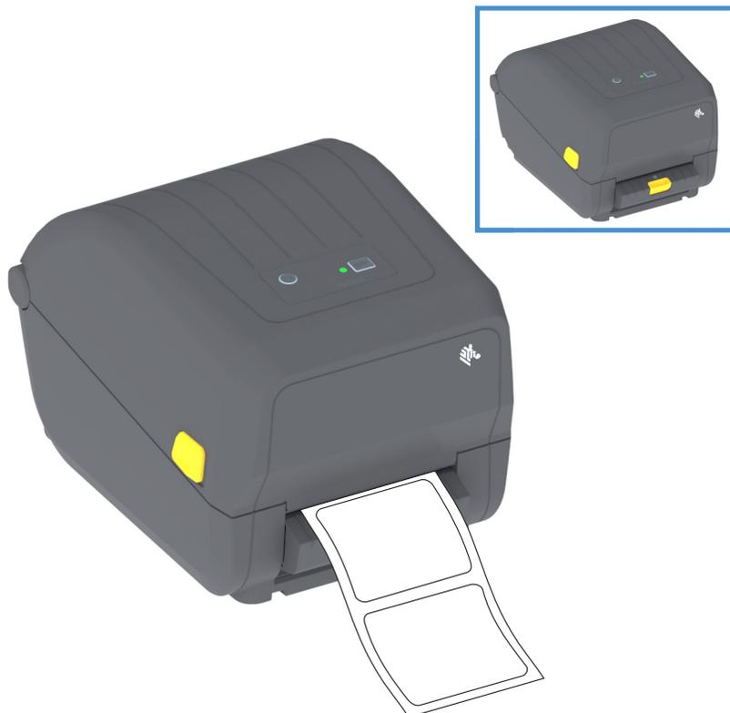
2. Поднимите подложку над верхней частью принтера. Оттяните защелку золотистого цвета в центре откидной крышки отделителя, чтобы она открылась.
