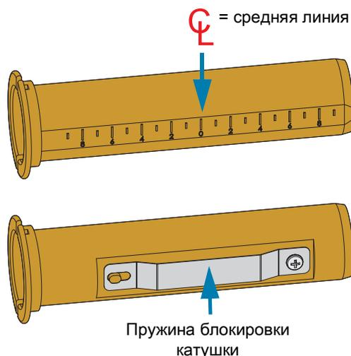
1. Заправьте пустую ленточную катушку в адаптер ленточной катушки. Пустая ленточная катушка должна быть той же ширины, что и рулон ленты (или быть шире). Приблизительно совместите центр катушки со средней линией адаптера. Вместо адаптера и пустой ленточной катушки стороннего производителя можно использовать ленточную катушку Zebra. Вместе с принтером поставляется одна пустая ленточная катушка 300 м.
