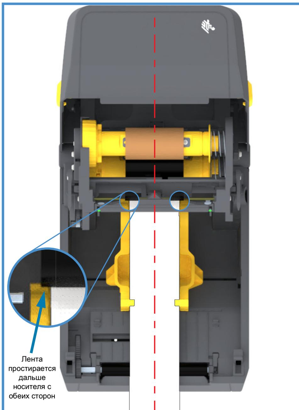
5. Прикрепите ленту к приемной катушке. Для прикрепления ленты к приемной катушке используйте тонкую полоску собственной липкой ленты, если используемый носитель не оснащен полоской липкой ленты на направляющей ленты, как в случае оригинальной ленты Zebra®. Выровняйте ленту так, чтобы она прямо подавалась на катушку.
