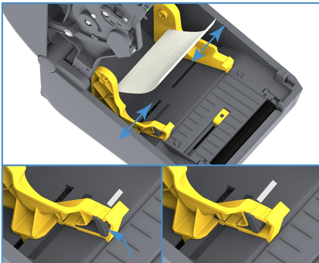
3. Вставьте носитель через прорезь в задней части принтера и поместите его между направляющими носителя и держателями рулона.
