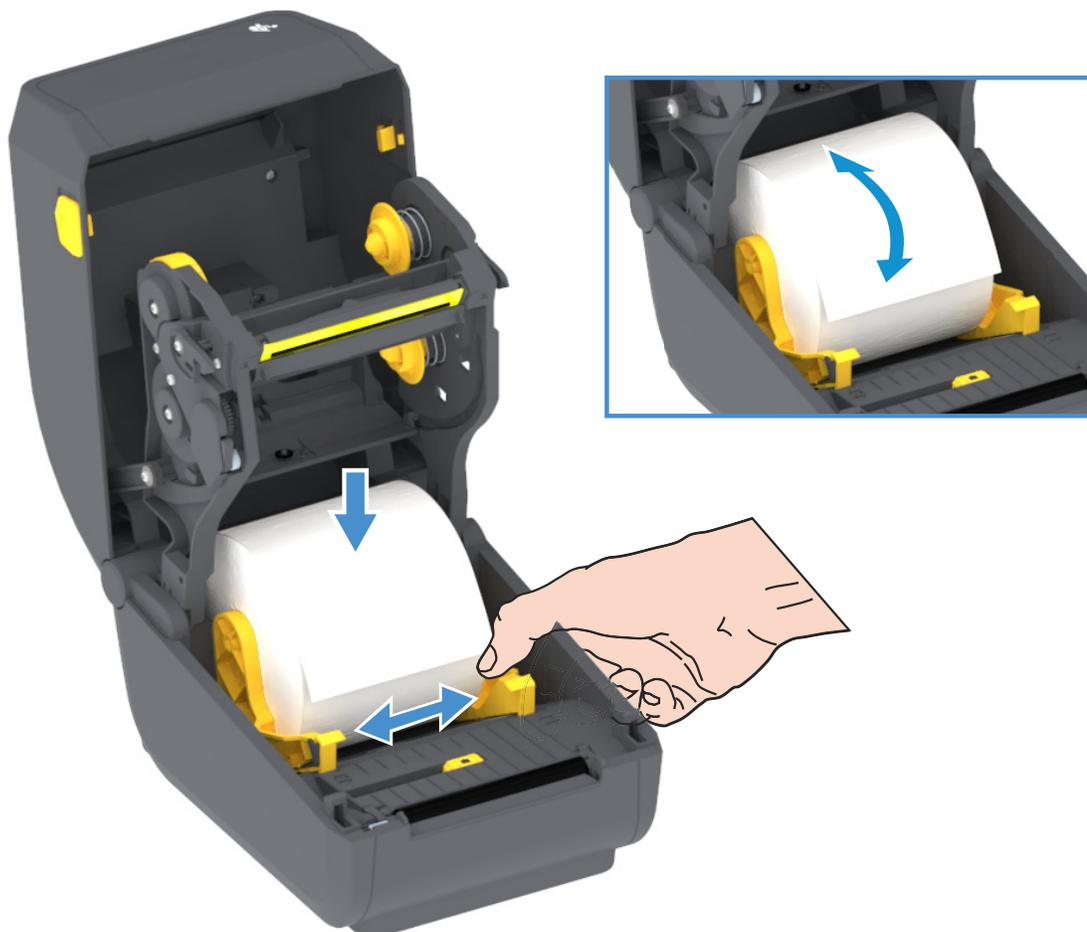
3. Потяните носитель так, чтобы он выступал за пределы передней части принтера.
