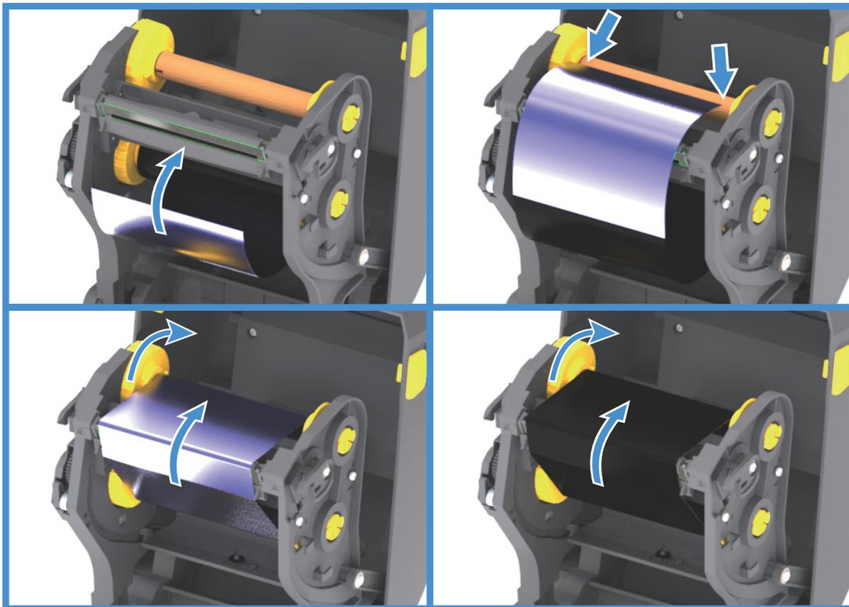
4. Поверните втулку приема ленты (верхняя часть должна двигаться в сторону задней панели), чтобы устранить провисание ленты. Поворачивание втулки поможет окончательно совместить положение ленты при приеме с положением подающего рулона ленты. Направляющая ленты должна полностью закрываться лентой.
