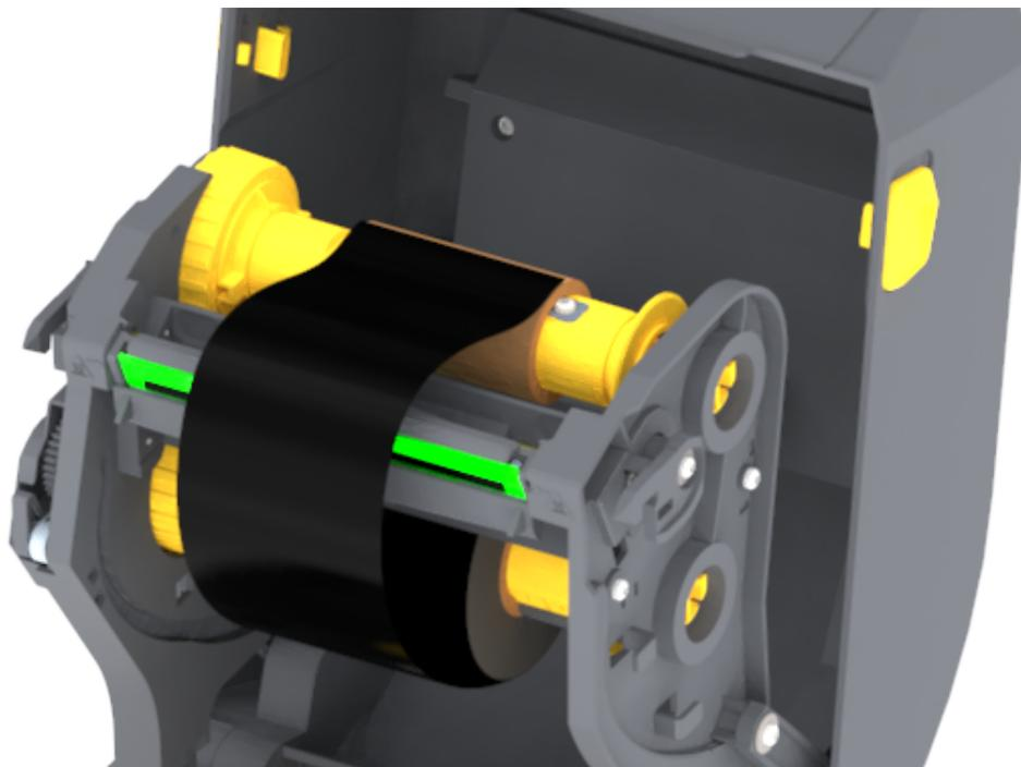
6. Поверните втулку приема ленты (верхняя часть должна двигаться в сторону задней панели), чтобы устранить провисание ленты. Поворачивание втулки поможет окончательно совместить положение ленты при приеме с положением подающего рулона ленты. Ленту следует намотать на приемную катушку, сделав не менее полутора витков.
