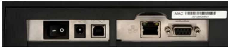
Принтер CL-S321 имеет Ethernet 10/100, RS-232 и USB 2.0 интерфейсы.
